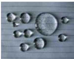
Fig. 8.- Disgregación del agua pura debida a la tensión superficial del agua, y por tanto, inhibiendo el proceso de limpieza.
