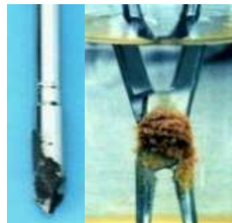
Fig. 18.- Picaduras causadas por clorina (Izq.) Instrumento quirúrgico depositado en agua salada. (Der.)
