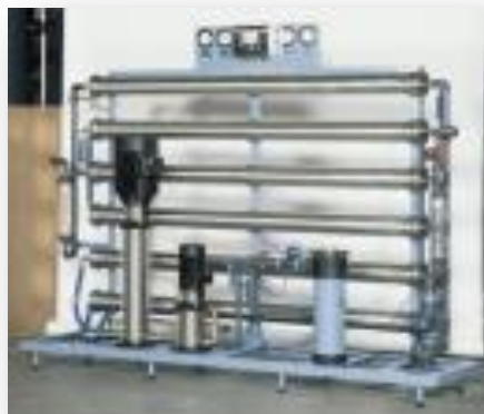
Fig. 21.- Unidad de osmosis inversa
