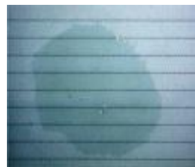
Fig. 9.- Surfactantes en agua jabonosa, lo que provoca que el agua se esparza mejor y se adhiera a la superficie.
