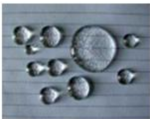
Fig. 8.- Disgregación del agua pura debido a la tensión superficial del agua, y por tanto, inhibiendo el proceso de limpieza.
