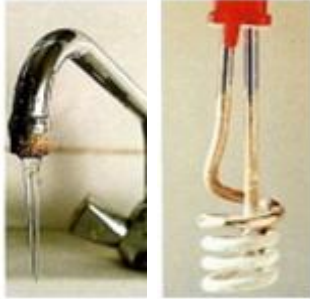
Fig. 17.- Depósitos de cal sobre un grifo y en un elemento calefactor debidos al uso de agua dura
