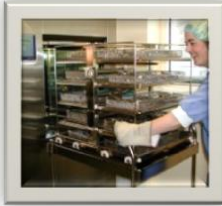
Fig. 13.- Descarga en una lavadora/ desinfectora automática
