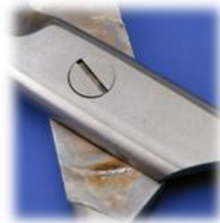
Fig. 4.- Tijeras con fricción por corrosión
